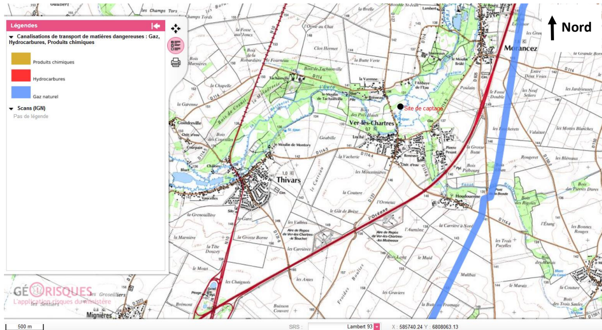
Figure 32 : Conduites de transport de matières dangereuses recensées à proximité des forages (source : Géorisques)
